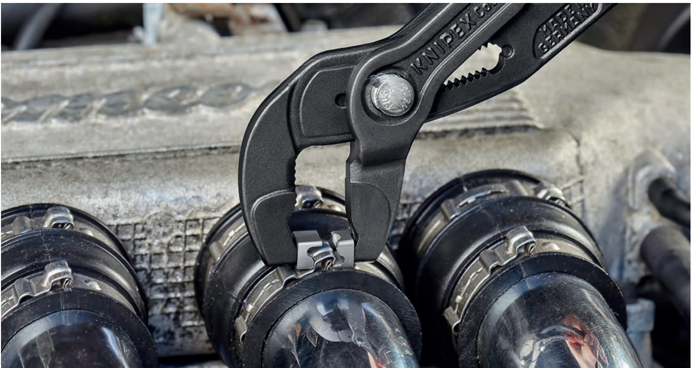
Öffnen einer Schlauchschelle ohne Anschlag
